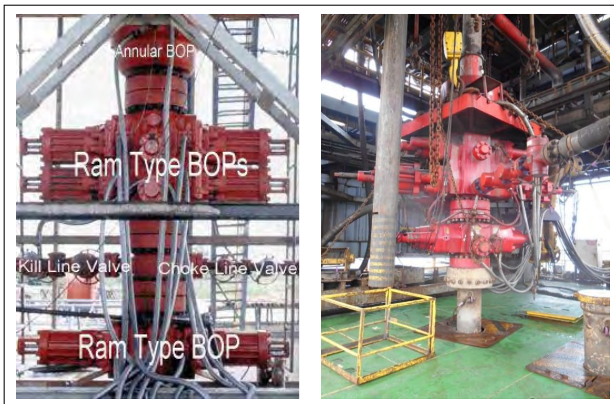
รูปที่ 2.3-2: ตัวอย่างอุปกรณ์ป้องกันการพลุ่ง (Blowout Preventer หรือ BOP) ที่ติดตั้งที่ปากหลุม
